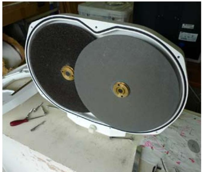
内部のプラスチックのプレートもプラスのねじ回しで外します。
